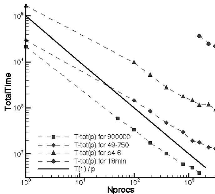
Рис. 3. Время счета в секундах в зависимости от числа процессов MPI для отыскания 100 младших собственных пар спектральных задач с симметричными положительно определенными матрицами.
