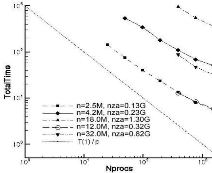
Рис. 2. Время счета в секундах в зависимости от числа процессов MPI для СЛАУ с симметричными положительно определенными матрицами
