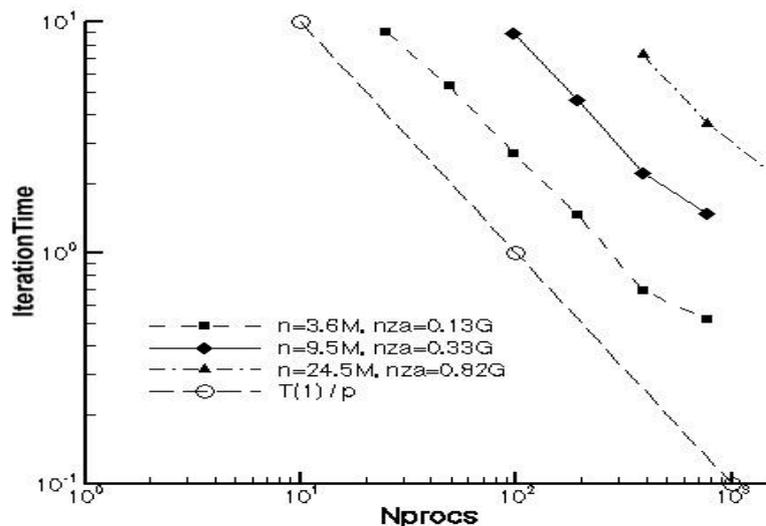
Рис. 1. Время счета в секундах в зависимости от числа процессов MPI для СЛАУ с несимметричными матрицами
